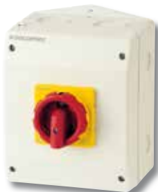
COMO CS w obudowie od 25 do 100 A Poliwęglan - IP65
